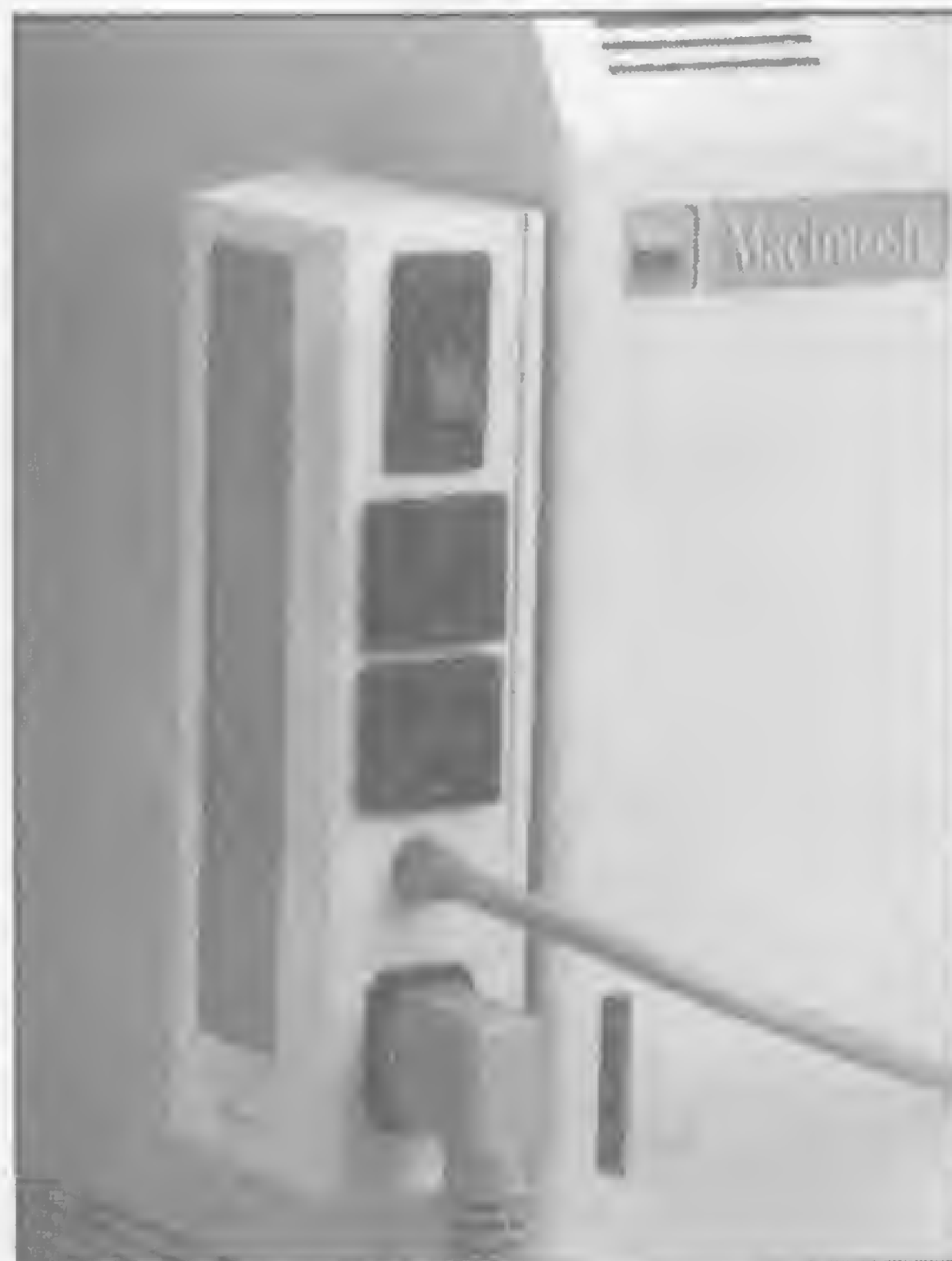
A foto mostra o Macintosh tendo ao seu lado o MacGuard, um dispositivo que protege o equipamento contra cargas eletrostáticas, surtos de tensão, corrente e interferências vindas pela rede elétrica.
